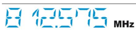
Drücken Sie die Taste kurz, wechselt die Anzeige zum nächsten bzw. vorherigen Wert. Wenn Sie in den Menüpunkten „CHAN“, „TUNE“ und „NAME“ die Taste **▲/▼** gedrückt halten, ändert sich die Anzeige fortlaufend (Repeat-Funktion). Sie gelangen so in beiden Richtungen schnell und komfortabel zum gewünschten Einstellwert.
